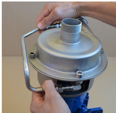
Fig. 3.5.6 Entfernen Sie das Metallrohr [1363].
