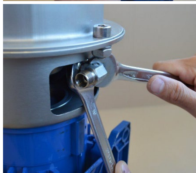
Fig. 3.5.7 Lösen und entfernen Sie die Winkelverschraubung [1367].
