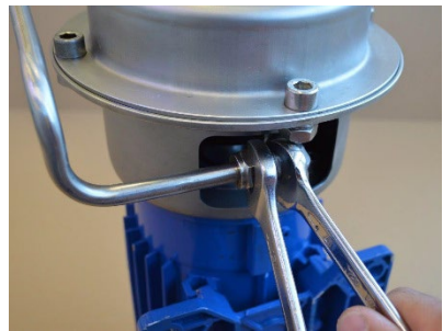
Fig. 3.5.5 Lösen Sie die Schraube an der Winkelverschraubung [1367].
