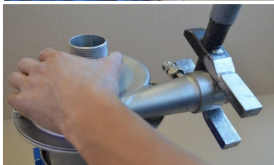
Fig. 3.5.8 Schrauben Sie den Verbindungsadapter [1364] ab.
