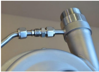
Fig. 3.5.4 Lösen Sie das Metallrohr [1363].
