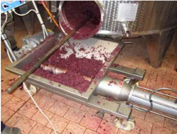
DHE pump Transfer of the fermented pomace
