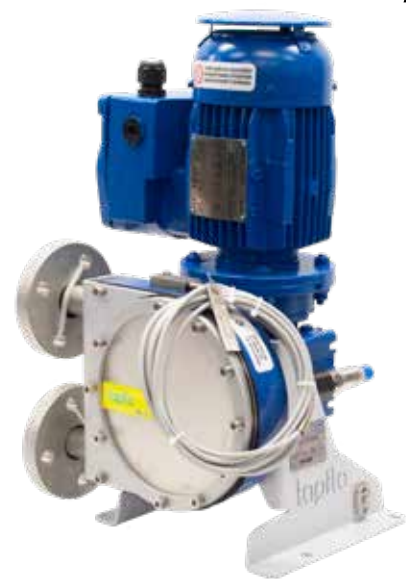
PXTL13 für ATEX Zone mit Flanschanschlüssen, Abdeckung für Motor, Temperatursensor und Schlauchbruchsicherung
