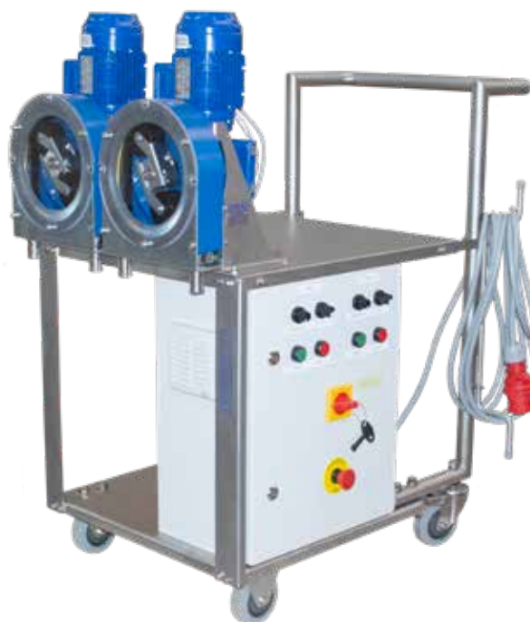
2 x PTL17 på en vogn med kontrolskab og eksterne omformere
